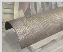
Recubrimiento de piezas sometidas a alta abrasión
